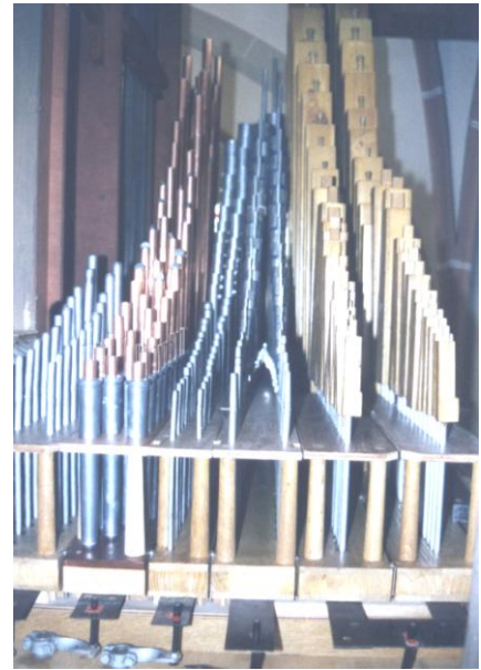
Orgelpfeifen: Ganz links die Prospektpfeifen, daneben das Krummhorn (Zungenregister). Die offene Oktave 2’ daneben die Rohrflöte 4’ und ganz rechts das Gedackt 8’
