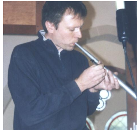
Aufschnittregulierung einer Pfeife mit anschl. Kontrolle (Dirk Banzhaf beim Intonieren einer Pfeife)
