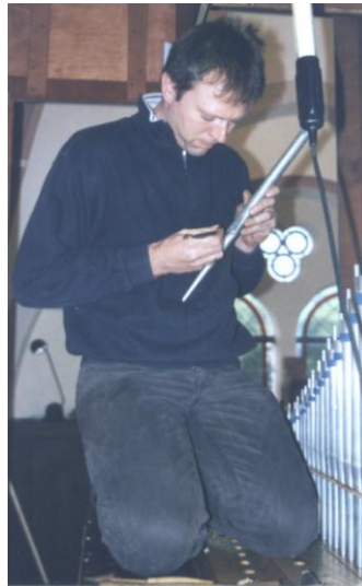
Aufschnittregulierung einer Pfeife mit anschl. Kontrolle (Dirk Banzhaf beim Intonieren einer Pfeife)
